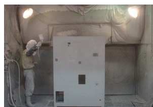
▲(オーバーホール) 塗装工程
